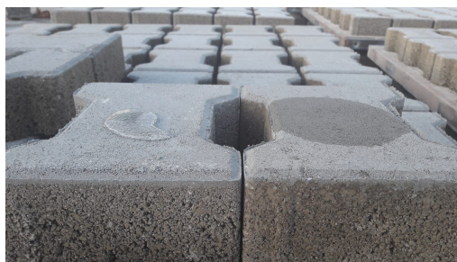
Betonski element tretiran sa Fasil V
